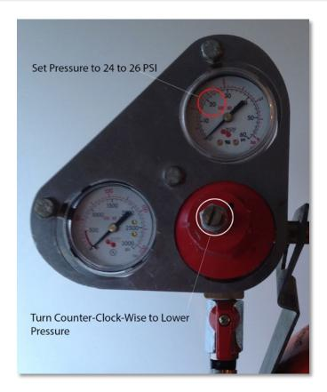
Lowering pressure slows down the pour times, raising the pressure speeds up the pour times.
